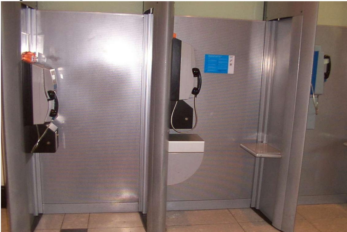
9- Teléfonos públicos: el primero de ellos más bajo, adaptado para personas en silla de ruedas o enanas. El segundo es un teléfono para sordos, con una especie de butaca que puede servir también de apoyo. El resto son teléfonos convencionales, con butacas de apoyo.
