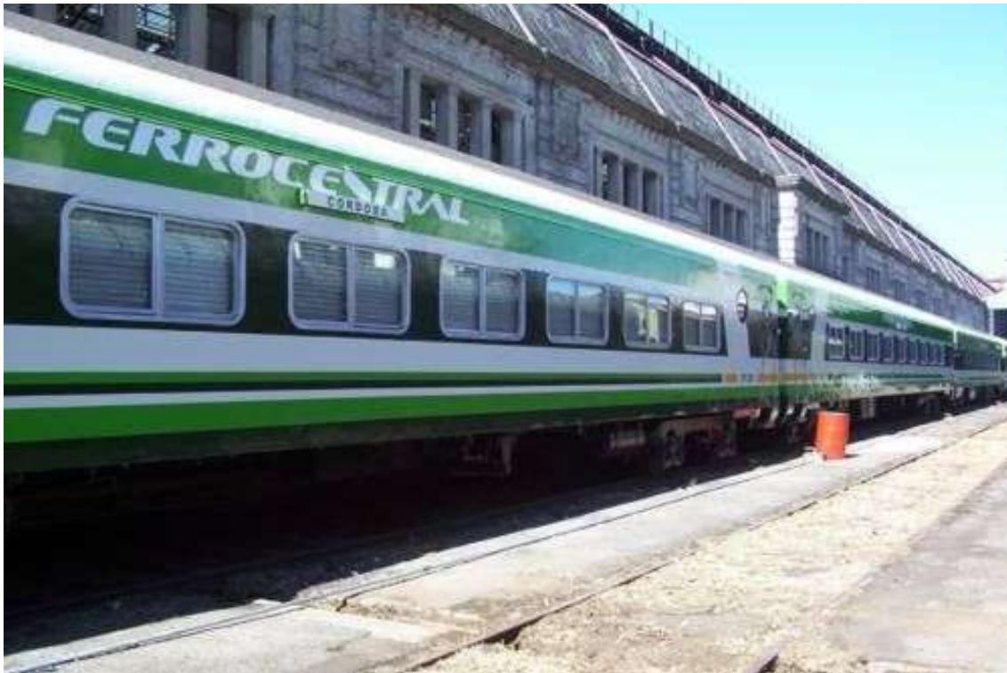
1- Vista exterior del tren donde puede observarse la distancia (en ancho) entre el borde del andén y los vagones, así como también la diferencia de altura entre la puerta de los vagones y el solado del andén.
