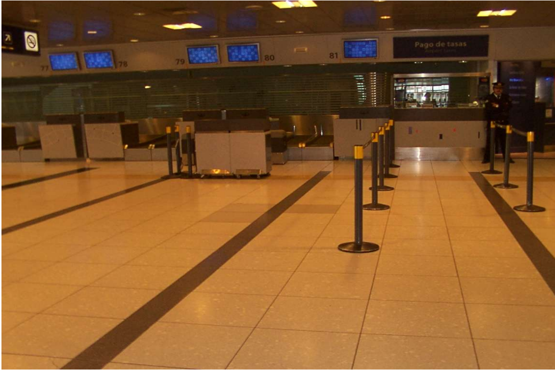
12- Mostradores de check in, con paneles de vidrio y superiores a 0,80 metros de altura. Vemos que delante de uno de ellos hay uno sin paneles, utilizado para atención de discapacitados.
